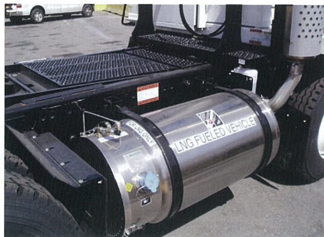
Imagem 1 - Reservatório de GNL instalado em camião
