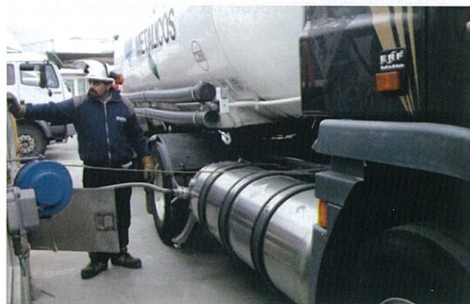
Imagem 2 - Operação de Abastecimento de camião com GNL
