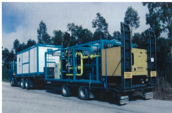
**Constituição da UAG Portátil** - A UAG Portátil é constituída por um skid (equipamento de Vaporização – Regulação – Odorização) e por um contentor onde está alojado todo o equipamento de aquecimento e controlo.
