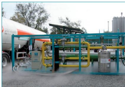
Além de funcionar de forma autónoma, a **UAG PORTÁTIL** permite ainda uma monitorização remota através de um sistema de comunicações.
